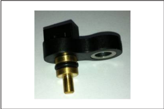
ATF油温传感器 变速器油温传感器安装在阀体内。
